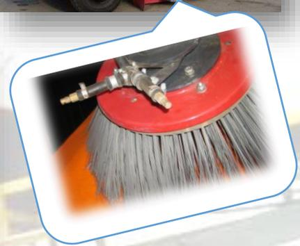
Предлагаем Вашему вниманию форсунки для орошения щеток и вальцов коммунальной техники, форсунки для реек высокого давления для мойки дорожного полотна, форсунок для пылеподавления при сухой уборке.
